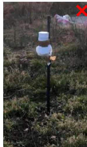
Champ du Ninox partiellement obstrué par le haut du piquet
