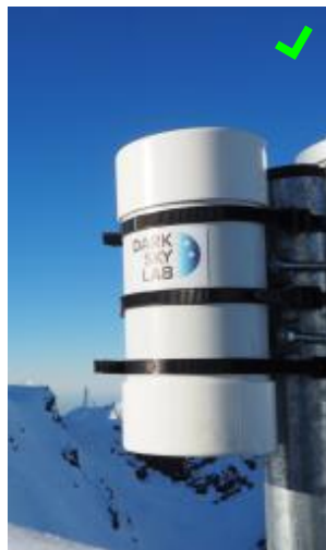
Ninox positionné en haut du piquet de fixation
