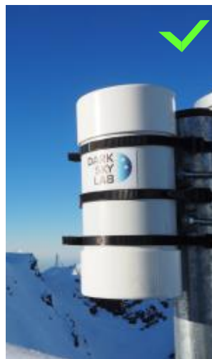
Ninox positionné en haut du piquet de fixation
